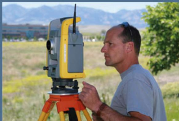
*Съемка с электронным тахеометром Trimble.*
