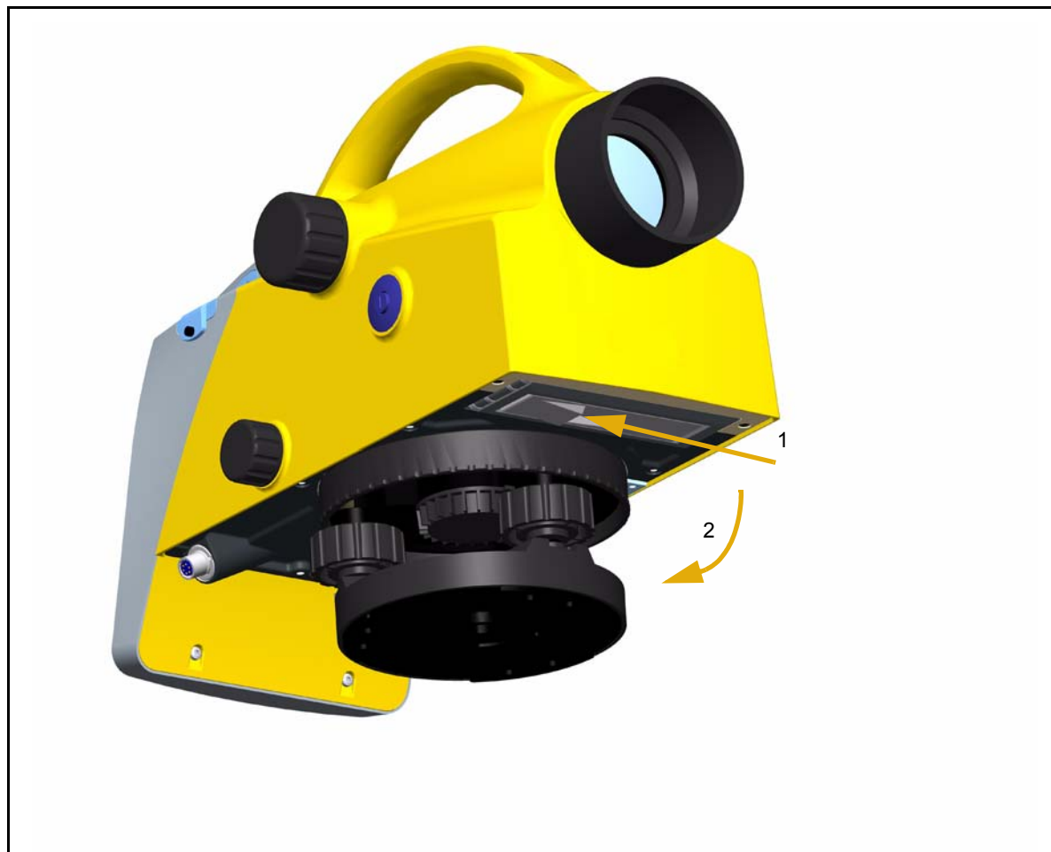
Рис. 3.1 Открытие батарейного отсека
