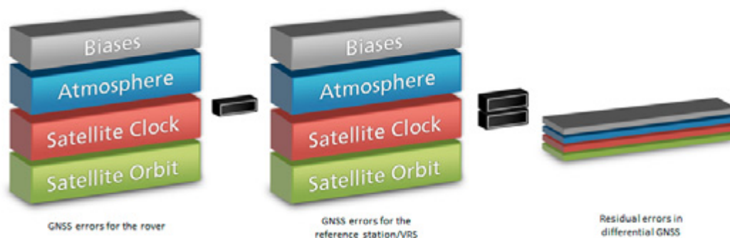
Рисунок 7. Моделирование ошибки дифференциальных RTK измерений при работе с одиночной базовой станцией или VRS
