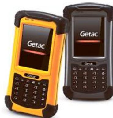
Рабочая температура от 30°C до +60°C. Современная широко используемая операционная система Windows Mobile® 6. На контроллере установлено специализированное ПО Stonex SurvCE.
